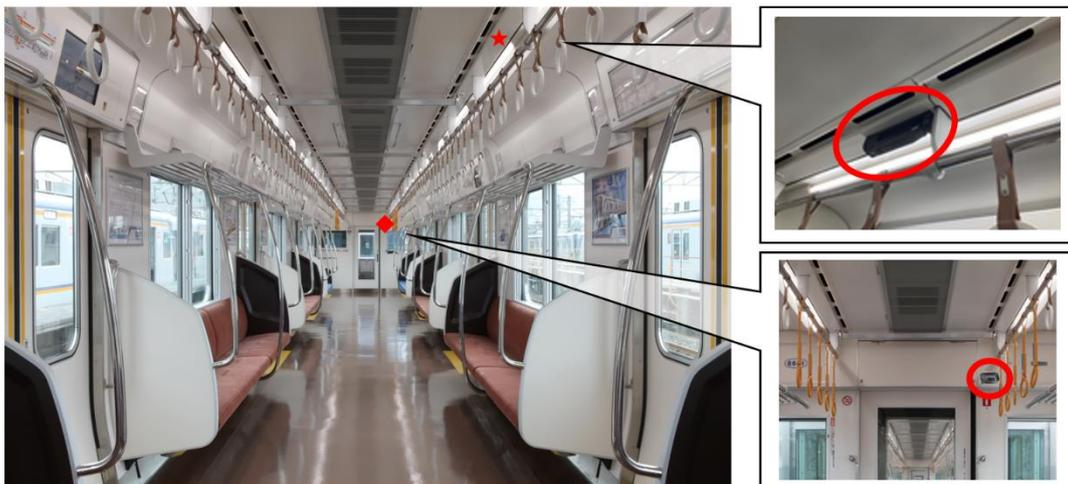
【図2】車内全景・防犯カメラの取り付けイメージ
