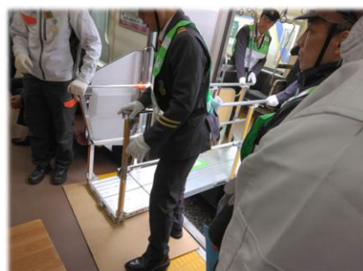
車両間渡り板設置（車両側面）
