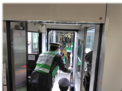
車両間渡り板設置（車両前面）
