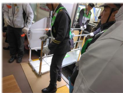
車両間渡り板設置（車両側面）
