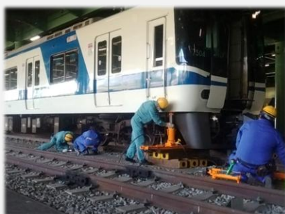
車両脱線復旧作業
