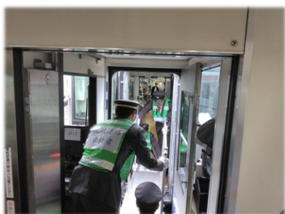
車両間渡り板設置（車両前面）
