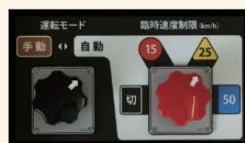
② 指令員の指示により臨時速度 制限設定操作を行う
