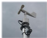
風速警報装置 12箇所
