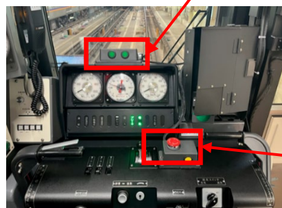
自動運転に必要な車上設備(乗務員操作部)
