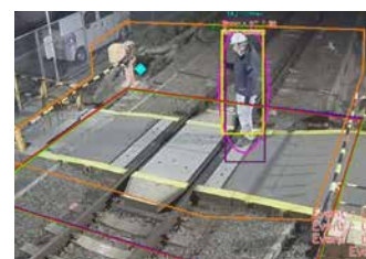
AIを用いた踏切異常検知システムの導入試験
