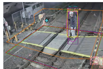
踏切異常検知システムのテストの様子
