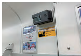
車内に設置している防犯カメラ
