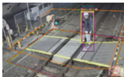
AIを用いた踏切異常検知システム
