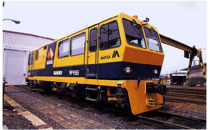
新型軌道検測車 (平成12年3月導入)
