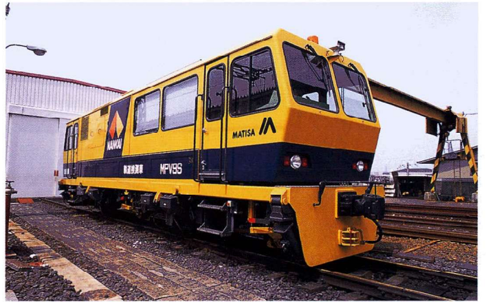
新型軌道検測車 (平成12年3月導入)
