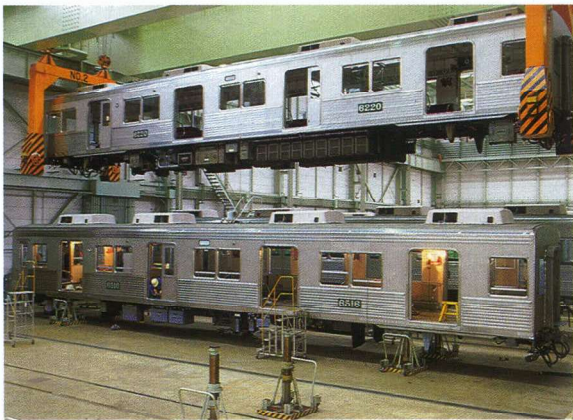
35トン天井走行クレーン(千代田工場)
