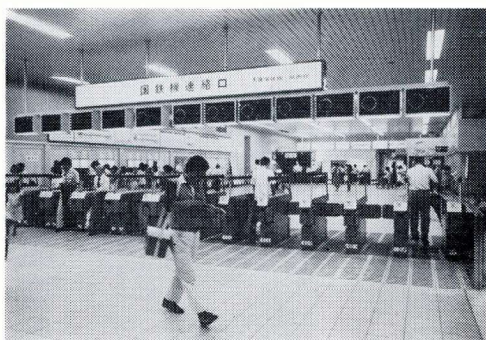
駅務自動化システム コンピュータとオンラインした駅務の装置化が進んでいる。写真は自動改札機を導入した新今宮駅コンコース
