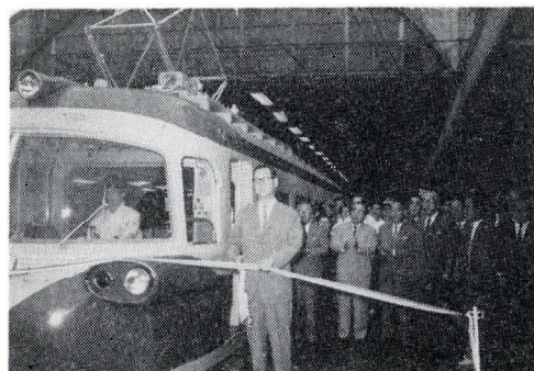
デラックス観光特急「新こうや号」 南海の看板列車にふさわしい外観と性能をもった二〇〇〇系ズームカー。三十六年七月にデビューし、三M一T四両固定（一編成、定員二百人）でボディはワインレッドとクリームイエローのツートンカラー。前面ガラスは当時としては最大級の曲面ガラスを用いたチャームングな「顔」をもつ。車内はモケット張り、三段チェンジの回転リクライニングシートなど、あまりの豪華さに、お年寄りが履物を脱いで歩いたという。写真は難波駅で、壺田修社長のテーブカット
