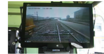
軌道作業車の操縦席に設置した「前方確認モニタ」
