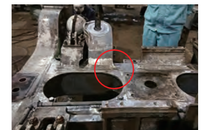
台車のき裂発生箇所
