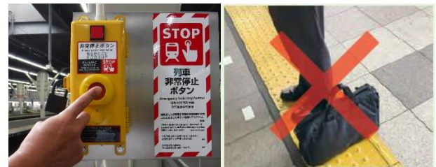
駅ホームの 非常停止ボタン
