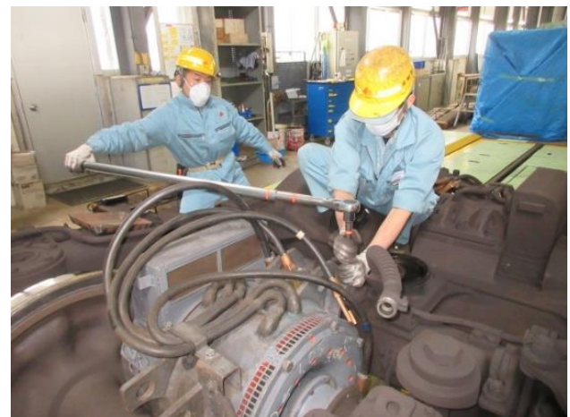
主電動機取替訓練 (運輸車両部・保守担当)
