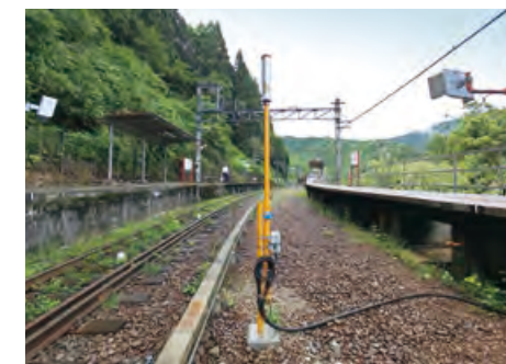
緊急時に作動する特殊信号発光機
