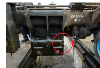
台車のき裂発生場所
