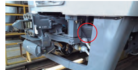
転落防止放送装置
